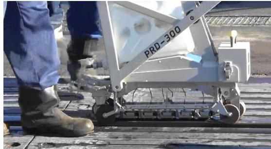
超音波探傷器による踏切内のレール検査
